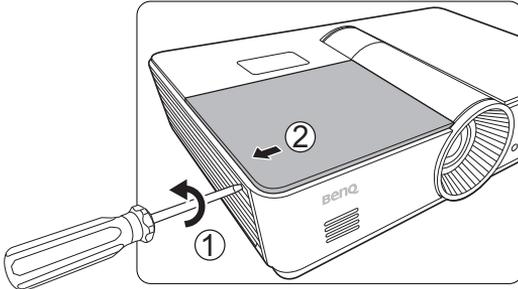
3. Retire la cubierta de la lámpara.
