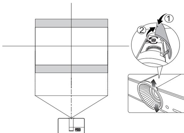
☞ El ajuste de desviación de la lente no degradará la calidad de la imagen. En el supuesto de que la imagen se distorsione, consulte ["Ajuste de la imagen proyectada"](#) en la [página 27](#) para más detalles.
