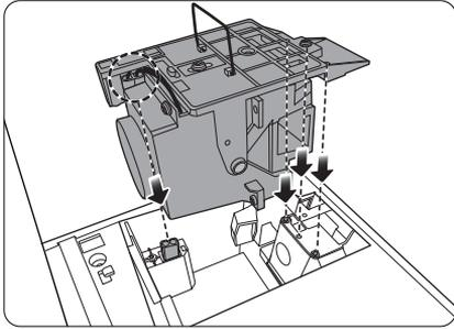
7. Asegúrese de que la palanca está totalmente bloqueada y en su lugar. Apriete el tornillo para fijar el compartimento de la lámpara.
