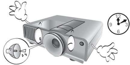
11. Durante el funcionamiento, la lámpara alcanza temperaturas extremadamente altas. Deje que el proyector se enfríe durante aproximadamente 45 minutos antes de retirar el conjunto de la lámpara para sustituirla.
