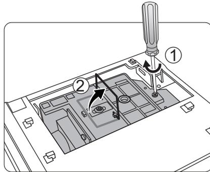
5. Levante la palanca para que quede perpendicular a la lámpara. Utilice la palanca para retirar la lámpara del proyector lentamente.
