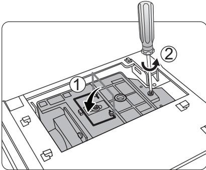
8. Sustituya la cubierta de la lámpara.
